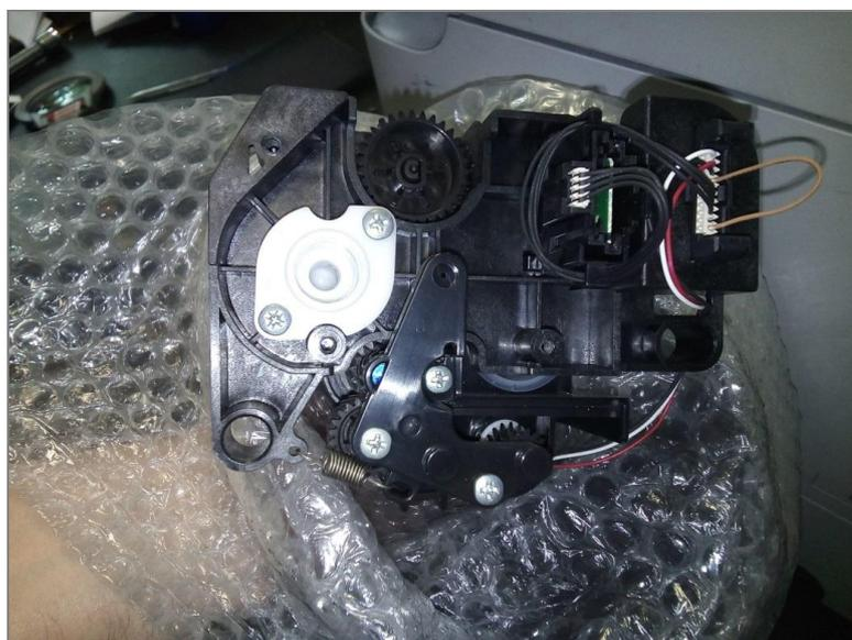
3. Извлеките модуль с чипом из корпуса. Разъём можно не отсоединять.
