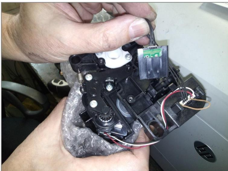
4. Плата чипа фиксируется в модуле защелкой. Проявите аккуратность при извлечении чипа.
