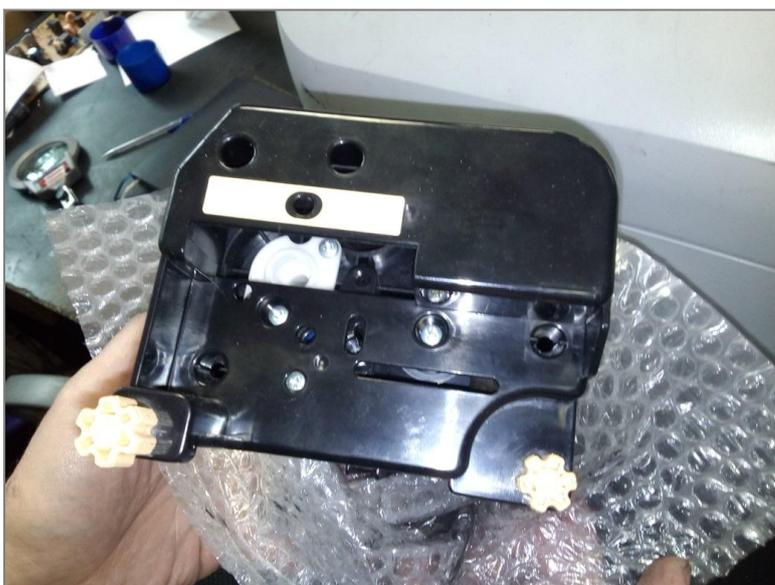
2. Открутите винты и снимите крышку. Крышка дополнительно фиксируется защелками.
